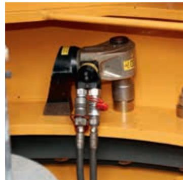
Drehkranz-Montage mit MX-EC
